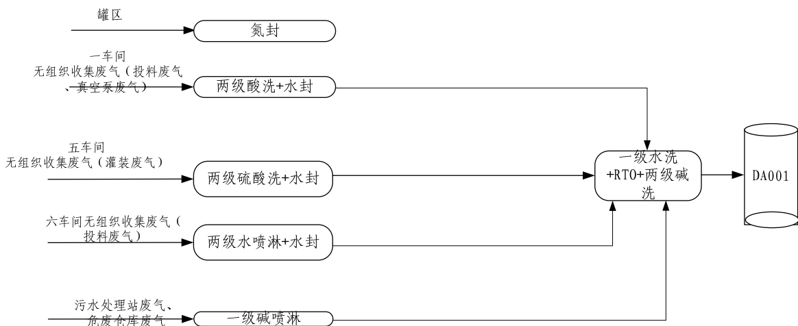
图 7.1-3 北厂区无组织废气污染物处理工艺流程图
